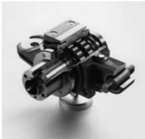
Rolamentos FAG de rolos cilíndricos com caixa de metal leve para um veículo de tráfego local
