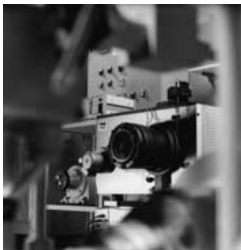
Bancada de ensaio para graxa FE8
