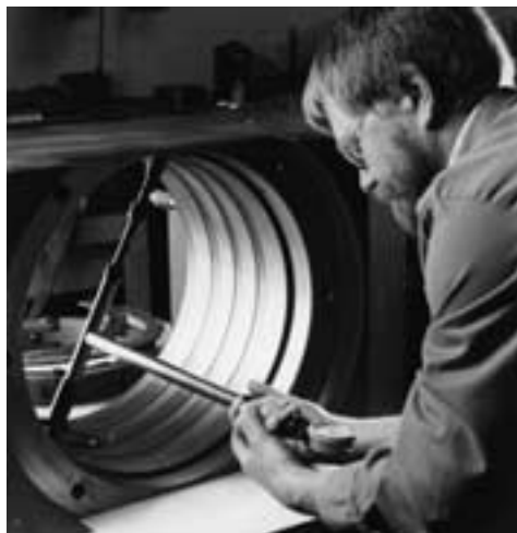
Medição do furo de um rolamento com um micrômetro interno
