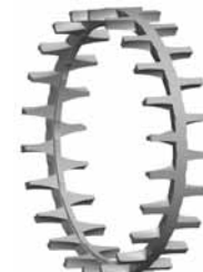
Fig. 8. Porta-rolos tipo pente usinado em peça única de bronze guiado pelo anel interno
