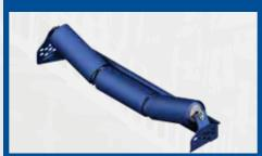
Os Roletes de Retorno com Canal **Inserido** são montados por baixo e por dentro da estrutura do transportador ou montados verticalmente e parafusados horizontalmente. O projeto de perfil baixo é usado com frequência em equipamentos móveis nos quais a redução da altura é muito importante. Estes roletes estão disponíveis em aço ou como Roletes de impacto.
