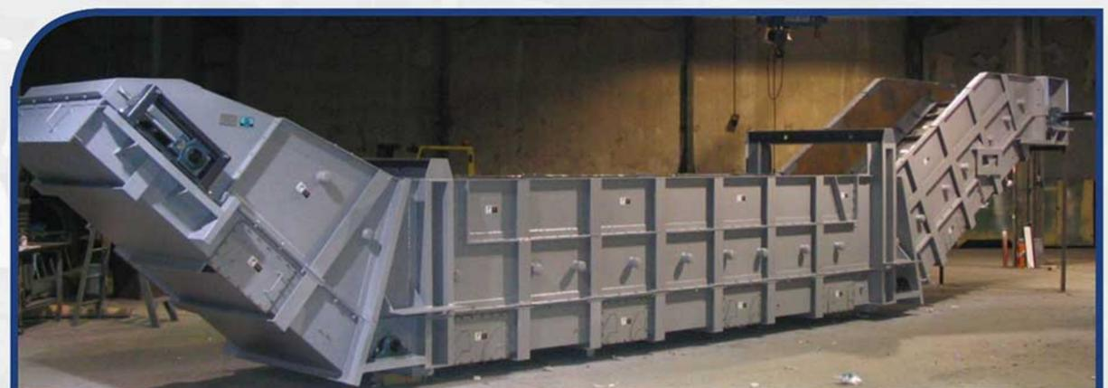
**Transportador de Corrente de Fabricação Especial (MTO)**
